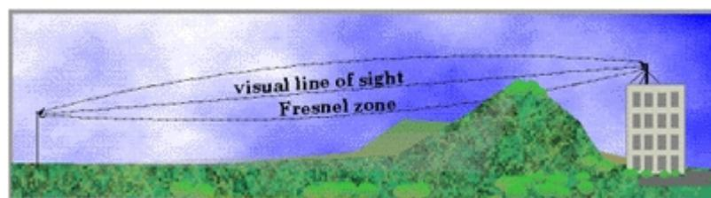
Come mostrato dalla figura sopra, quando un oggetto solido (collina, palazzo, ecc.) penetra nella zona di Fresnel (pur non attraversando la LOS), fenomeni di diffrazione possono deviare parte del segnale. Inoltre, poiché i segnali deviati non sono in generale in fase con il segnale originale, possono ridurne la potenza o cancellarlo totalmente (fenomeno dei cammini multipli e dell'interferenza distruttiva). Infine ostacoli come gli alberi possono attenuare il segnale.
