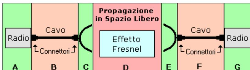
Nello schema ciò che è rosso/arancione indica le perdite di potenza, ciò che è verde indica i contributi positivi (guadagni) alla potenza. Il sistema mostrato in figura è una schematizzazione grossolana, ma abbastanza vicina, di un sistema realmente reale.
